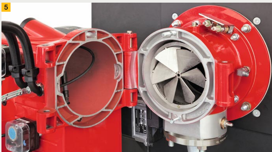
Apertura di 90° per permettere l'estrazione del cilindro fiamma
