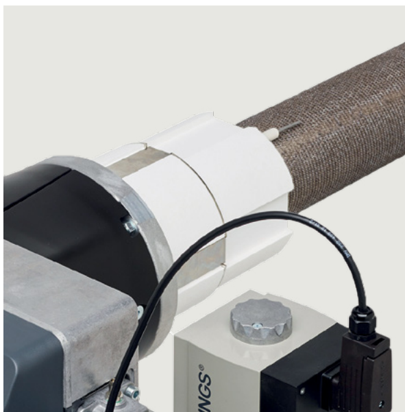
Standardno vgrajeni izolator ščiti komoro za predmešanje, v kateri je vnetljiva mešanica goriva in zraka, pred toplotnimi obremenitvami. To je odločilen varnostni vidik te tehnologije gorilnikov.
