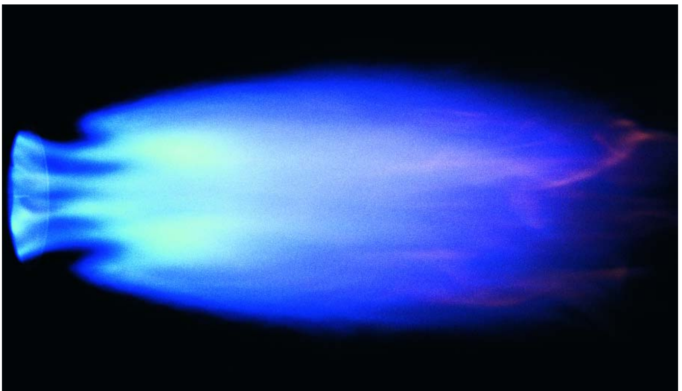
Typický snímek plamene u plynových hořáků v provedení LN (LowNO x )
